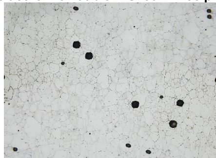
Figura 3 Microestructuras de acero inoxidable AISI 304. Precipitación de carburos de cromo.
