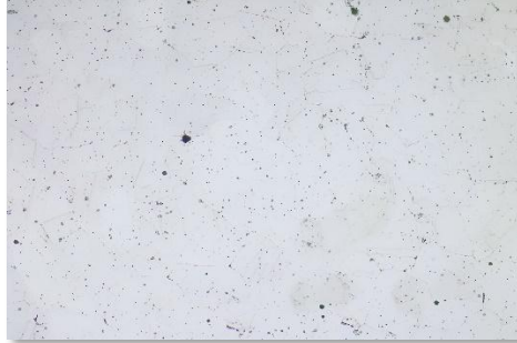
Figura 2 Microestructuras de acero inoxidable AISI 304. Presencia de corrosión intergranular.
