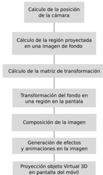
Figura 2 Diagrama de la creación de la imagen.
