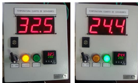
Figura 10 Vistas frontales del monitor de temperatura construido.
