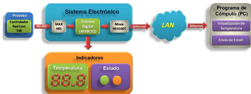
Figura 3 Diagrama de bloques del sistema desarrollado.
