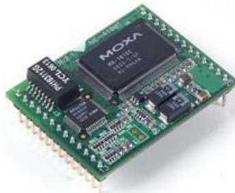
Figura 6 Módulo convertidor NE4100T de Moxa Inc.
