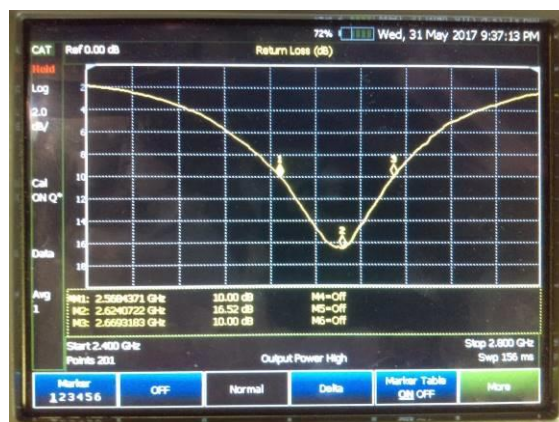
Figura 8 Pérdidas por retorno de la antena de parche fractal tipo E de dos iteraciones.
