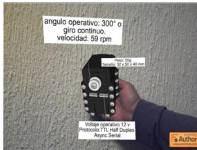
Figura 7 Motor del Robot Bioloid Premium con sus características en realidad aumentada.
