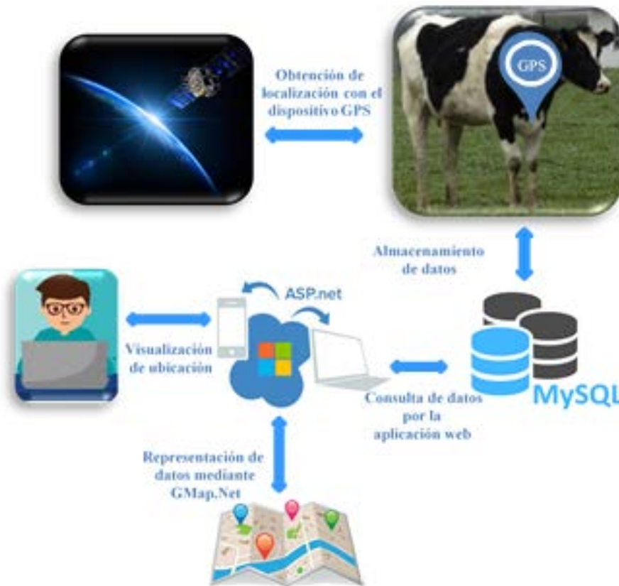
Figura 1 Estructura del sistema de monitoreo de ganado.
