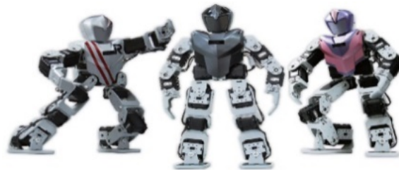
Figura 2 Robot Bioloid Premium ensamblado con forma humanoide.
