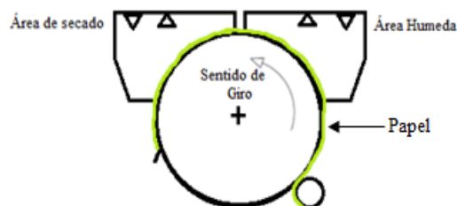
Figura 3 Cilindro de secado de papel basado en la propuesta original.
