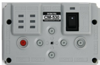
Figura 3 Control CM-530 del robot Bioloid Premium.
