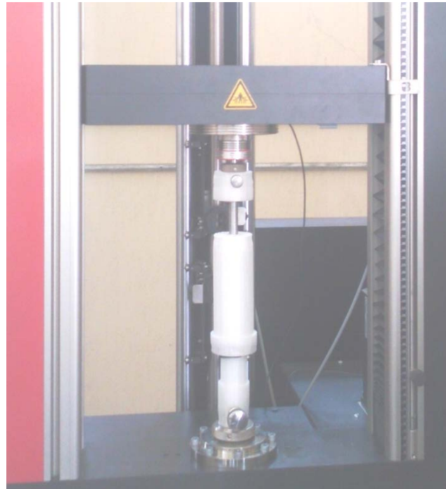
Figura 14 Prototipo montado en la máquina universal de tensión.
