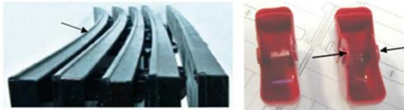
Figura 2 Deformación debido a esfuerzos residuales en componentes plásticos moldeados por inyección [7].
