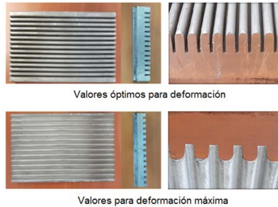
Figura 10 Insertos en aluminio fabricados por hilo-electroerosión.
