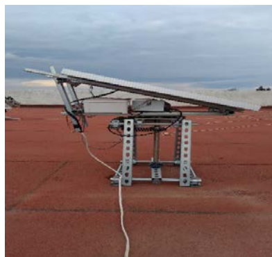
Figura 21 Seguidor solar de un eje.
