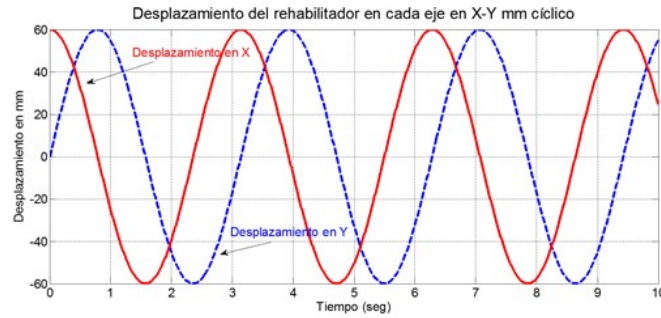
Figura 17 Trayectoria X y Y de guías lineales respecto al tiempo del movimiento circular.
