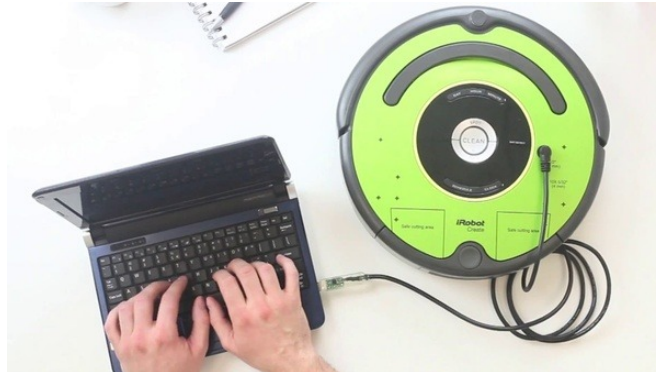
Figura 1 Robot móvil iRobot Create 2 programado por puerto serial con la interfaz proporcionada por el fabricante.
