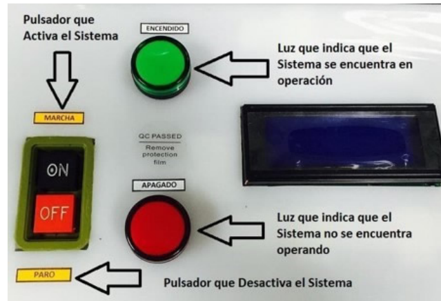
Figura 11 Interruptores para activar/desactivar el sistema.
