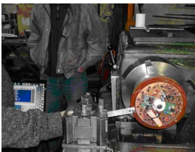
Figura 5 El sistema colocado en un torno para simular el giro de la rueda.
