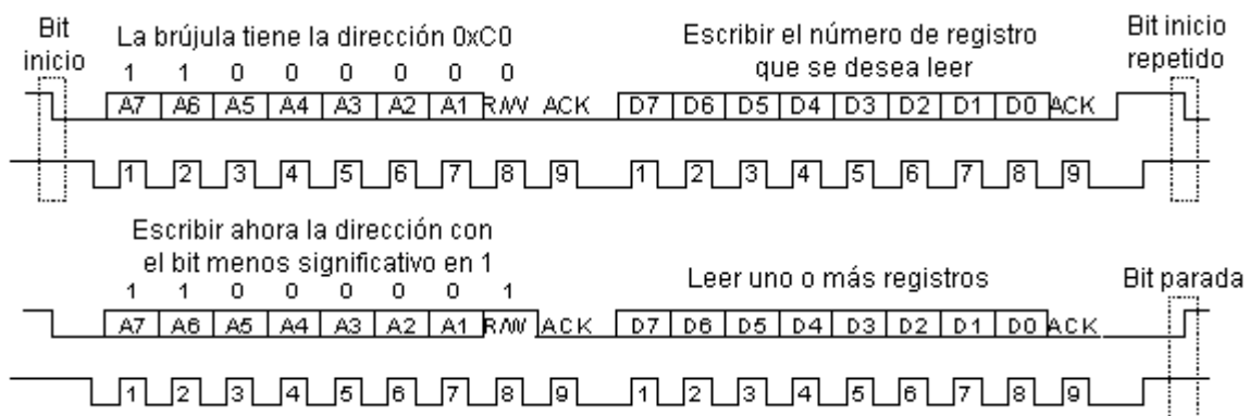
Figura 4 Trama de comunicación del bus I2C.
