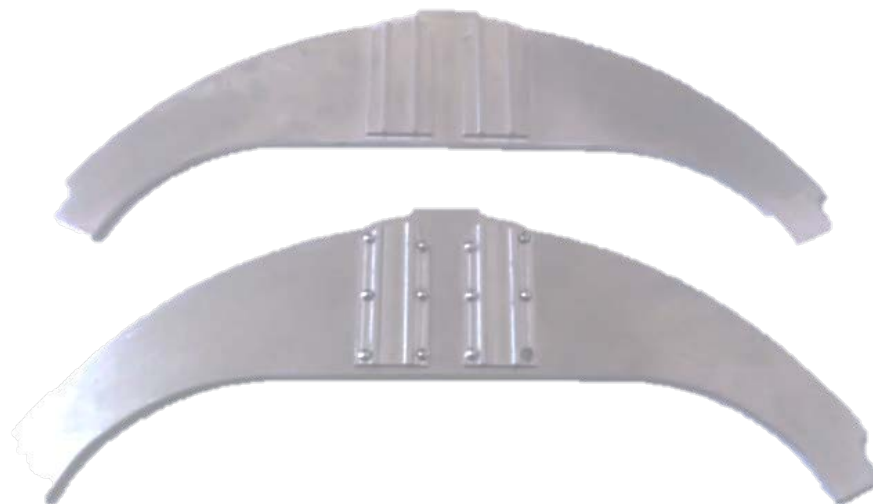
Figura 3 Pieza propuesta maquinada y componente ensamblado base aluminio 6061 T6.
