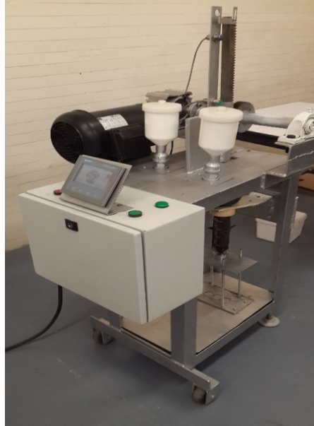
Figura 13 Máquina mezcladora de poliestireno y arcilla.
