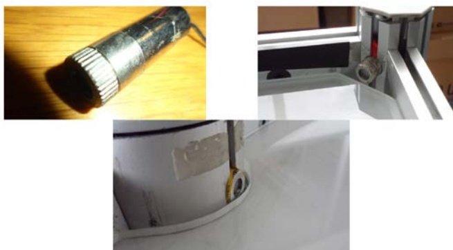
Figura 6 Láseres y su instalación.
