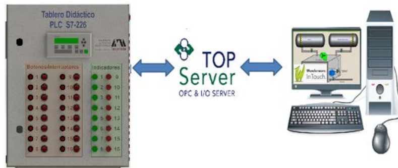
Figura 7 Intercambio de información utilizando TOP SERVER.
