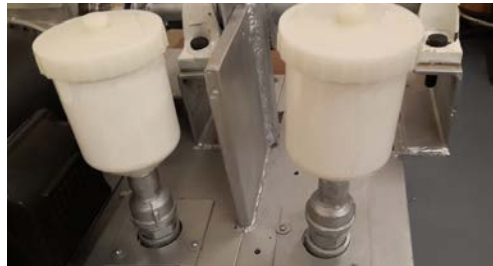
Figura 9 Contenedores para dosificar los materiales.
