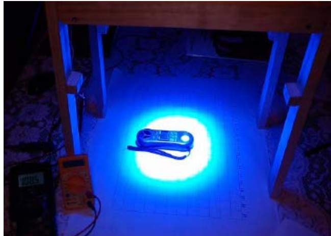
Figura 4 Medición de Iluminancia.
