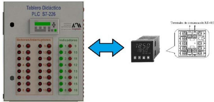
Figura 11 Control de lavado utilizando control de temperatura Comercial.
