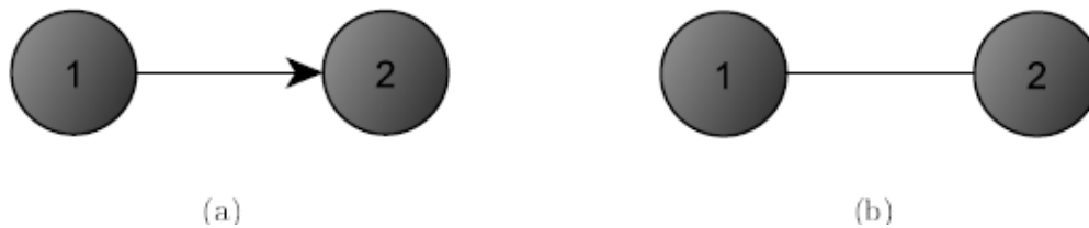
Figura 6 Configuración unidireccional (Maestro-esclavo). (b) Configuración bidireccional.
