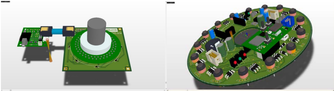
Figura 11 Modelo 3D del encoder magnético versión 1 y versión 8.
