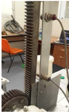
Figura 11 Mecanismo Cremallera-piñón para controlar la inyección.
