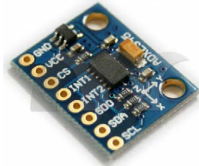
Figura 3 Acelerómetro modelo adxl345. [15]
