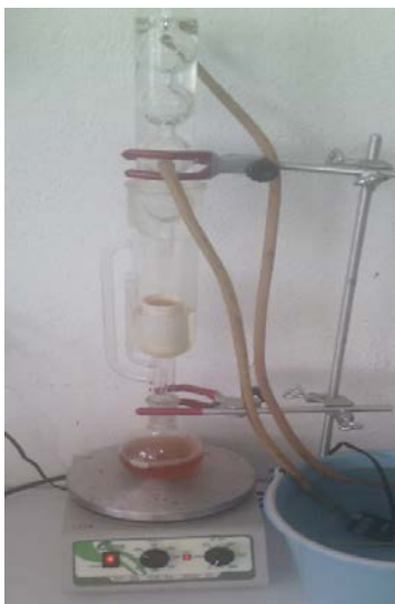
Figura 4 Proceso de extracción utilizando el método SOXHLET.
