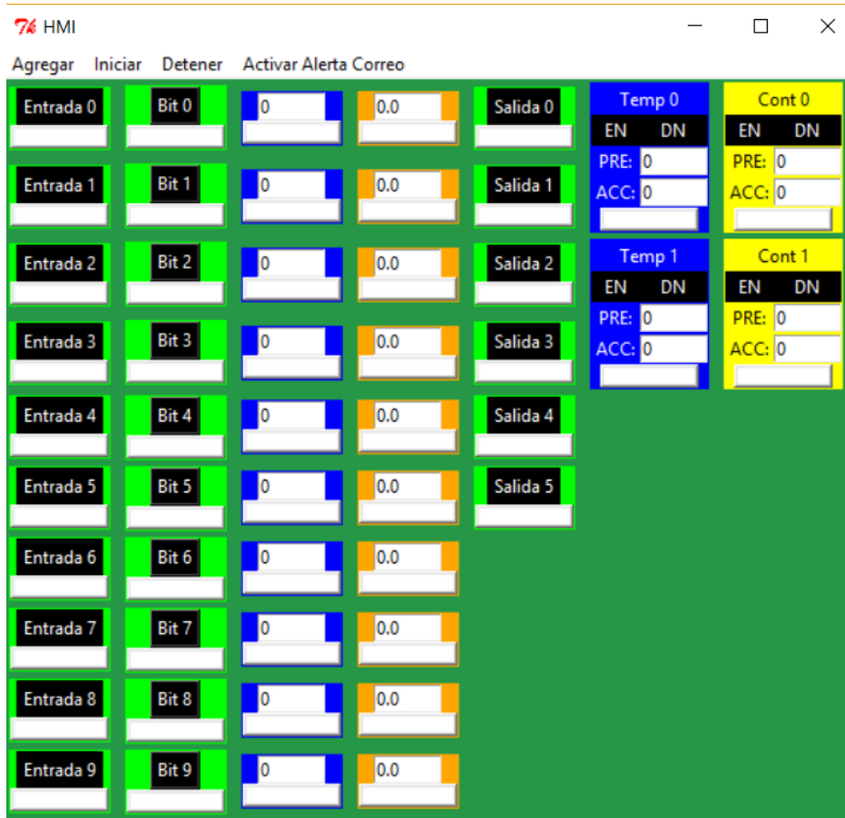
Figura 7 Interfaz de monitoreo con todos los elementos.
