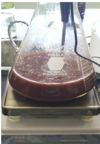
Figura 2 Mezcla de solvente y aserrín en termoagitador a una temperatura de 90 °C.
