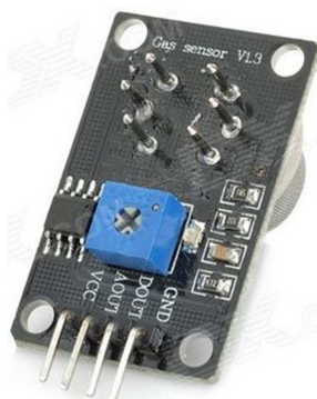
Fig. 5. Distribución de terminales del sensor MQ-2.
