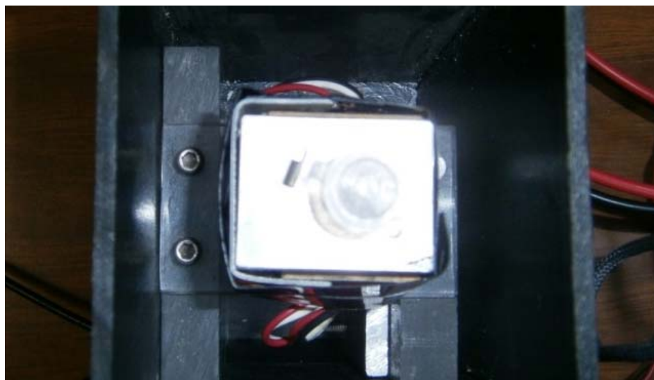
Fig. 4. Primer prototipo con celda para probeta de muestra, LED UV y detector.
