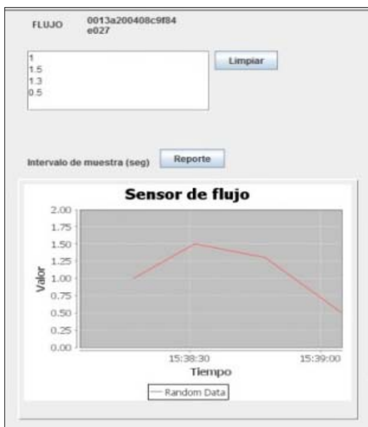
Fig. 3. Panel para la visualización gráfica en tiempo real de la información del sensor.
