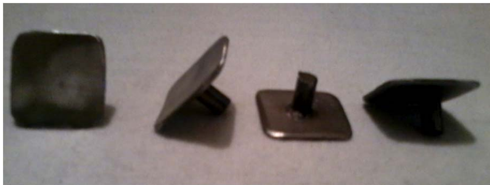
Fig. 7. Electrodo hechos de acero inoxidable.
