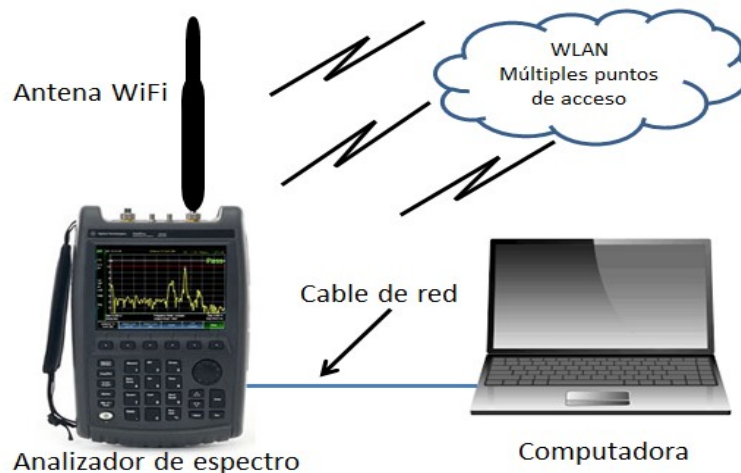
Fig. 2. Esquema para la recolección de las mediciones.
