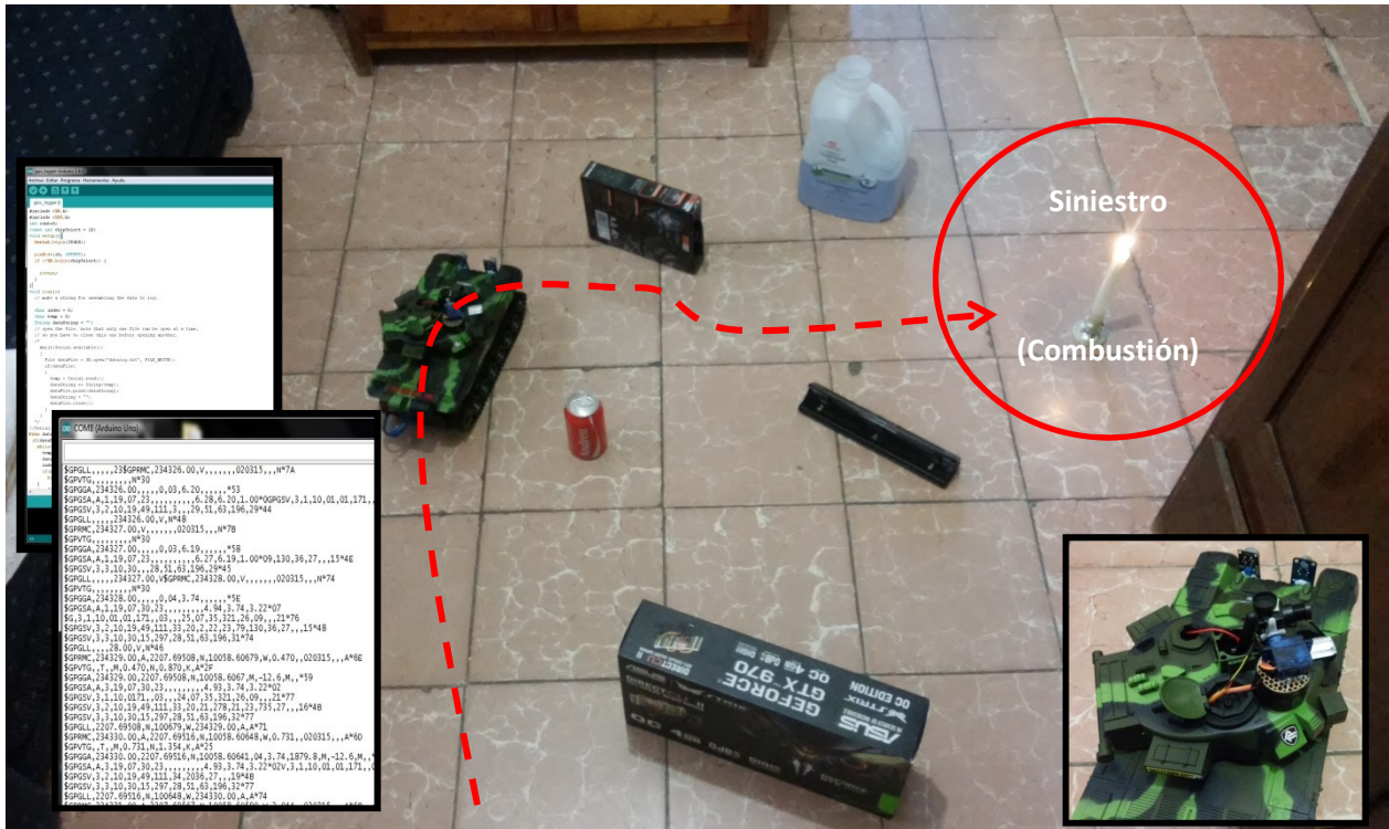
Fig. 12. UGV en modo semiautónomo rastreando emisiones de CO2.
