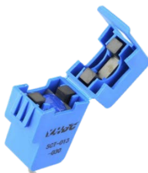
Figura 2 Sensor de corriente alterna no invasivo que mide intensidades de hasta 30Ac.
