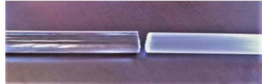
Figura 3 Ruptura en barra transmisora.
