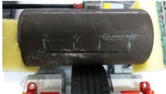
Figura 14 Discontinuidad geométrica a 40mm del borde de la tubería.
