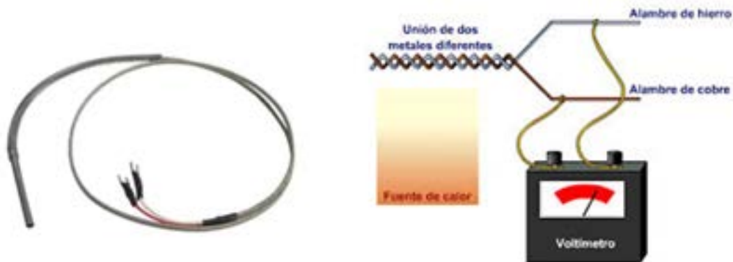
Figura 1 Termopar tipo J (izquierda) y forma usual de sensar (derecha).
