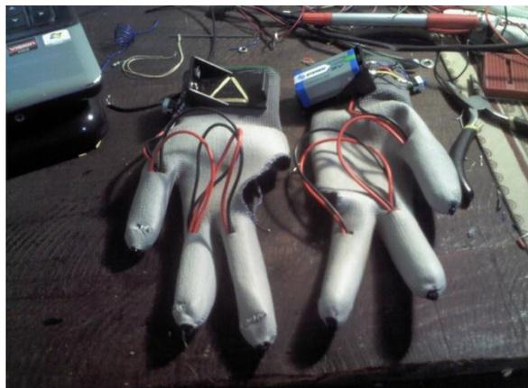
Figura 2 Construcción de los guantes con leds IR.
