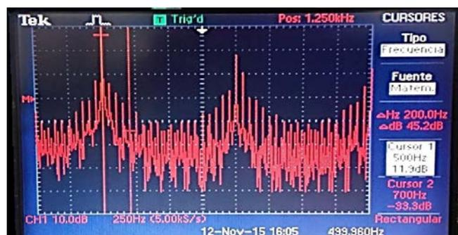
Figura 18 Vista en el osciloscopio y en el dominio de la frecuencia de un tren de pulsos codificado con el código de línea Manchester.
