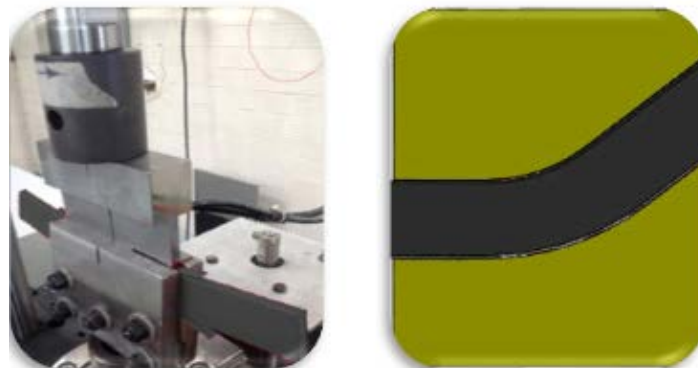
Figura 1 Proceso de rolado del cable y vista frontal de los herramientas y el cable.
