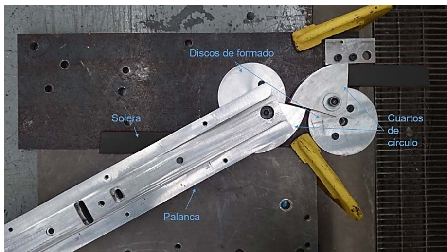
Figura 5 Componentes del mecanismo de rolado manual.
