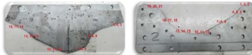
Figura 4 Puntos de medición de rugosidad en el herramientales de acero: Punzón y Matriz.
