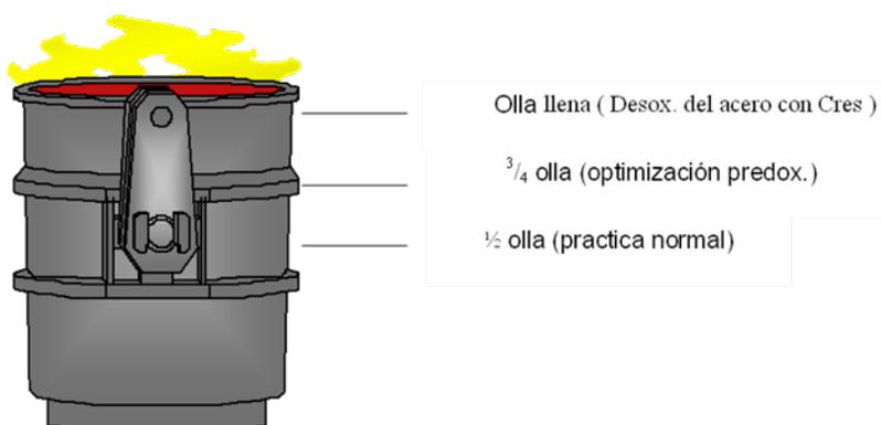
Figura 3 Niveles y tipos de pruebas para optimizar el de carbón para desoxidar el acero.
