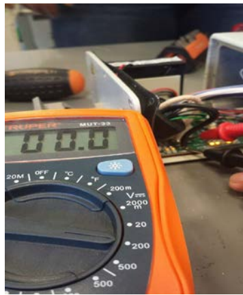
Figura 9 Medición de voltaje en el robot descompuesto.
