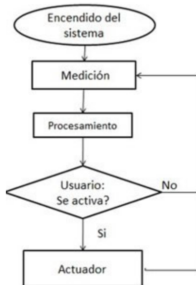
Figura 8 Funcionamiento del control climático modo manual.
