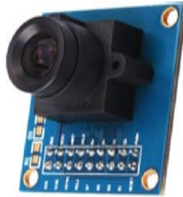
Figura 2 Sensor de imagen OV7670
