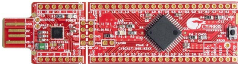
Figura 5 Microcontrolador PSoC CY 8C4128AXI-483 sistema de monitoreo inalámbrico.
