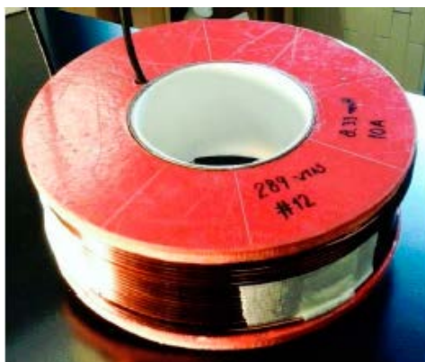
Figura 8 Aspecto del inductor de 8.0 milihenrys a 10 amperes.
