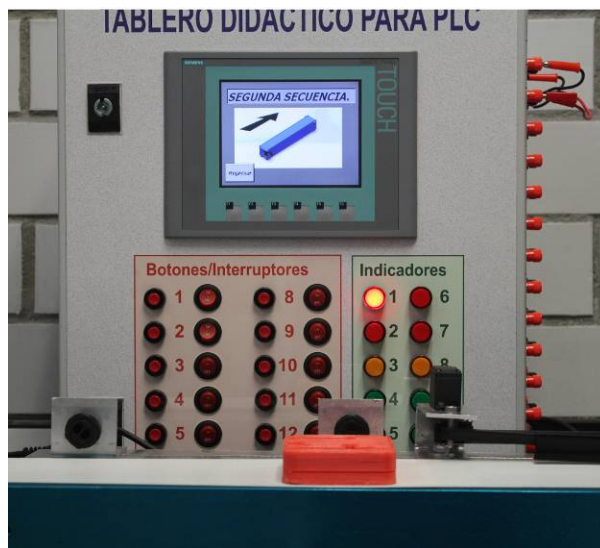
Figura 17 Vista de la implementación del interface Hombre-Máquina del ejemplo descrito.
