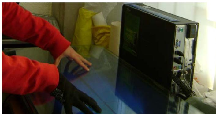
Figura 19 Prueba de toques simultáneos y a través de tela.
