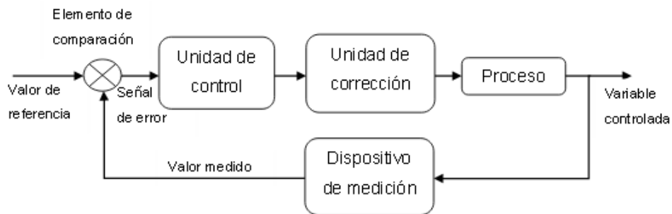
Figura 1 Elementos más importantes de un sistema de control retroalimentado.
