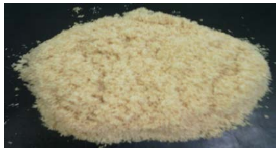
Figura 1 Virutas con tamaño de partícula de 4 mm 2 posterior al triturado.
