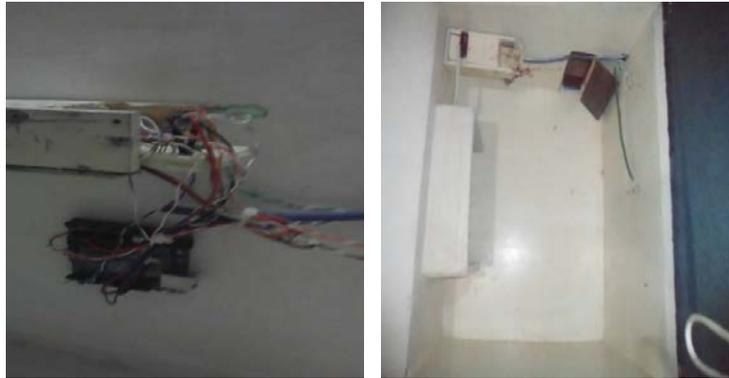
Figura 5 Acoplamiento del circuito de control.
