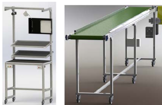
Figura 3 Puestos de trabajo y de la banda transportadora del sistema mecánico.
