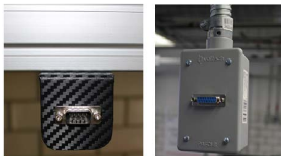
Figura 13 Conectores de señales del sistema construido.
