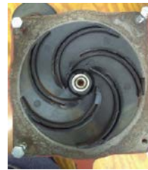
Figura 4 Impulsor de nylon 66 GF30
