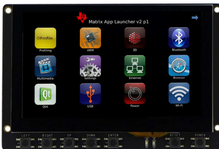
Fig. 2. Pantalla LCD capacitiva multitáctil.
