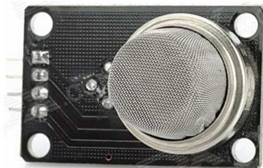
**Fig. 4. El sensor MQ-2.**
