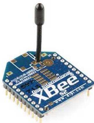
**Fig. 6. Circuito XBee Serie 2.**
