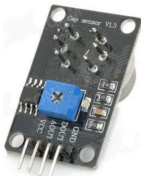
**Fig. 5. Distribución de terminales del sensor MQ-2.**
