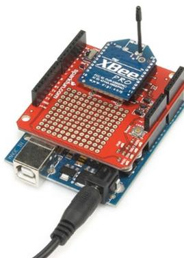
**Fig. 4. Tarjeta Xbee Shield.**
