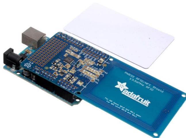
**Fig. 3. Shield de NFC Adafruit para Arduino.**
