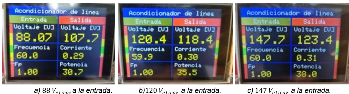
Figura 14 Regulación de voltaje de salida con diferentes valores a la entrada.
