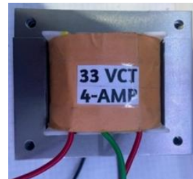
b) Transformador terminado.
