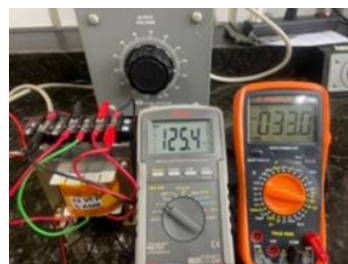
Figura 11 Prueba de funcionamiento del transformador principal.
