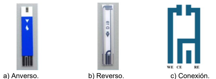
Figura 1 Tira reactiva e identificación de sus electrodos.
