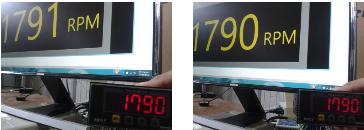
Fig. 8. Velocidad calculada y medida para un motor de cuatro polos, error \pm 1 rpm.
