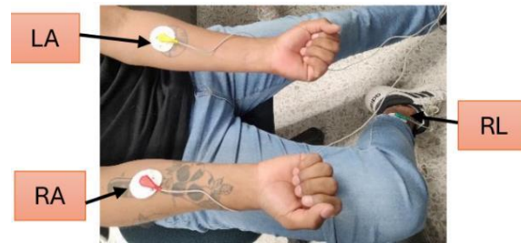
Figura 5 Ubicación de los electrodos en el sujeto de pruebas para el registro del ECG.
