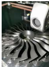
Figura 8 Impresión 3D de la pieza denominada fan o ventilador.
