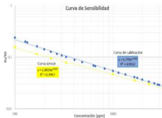
Figura 11 Curva de calibración del Mq-4.
