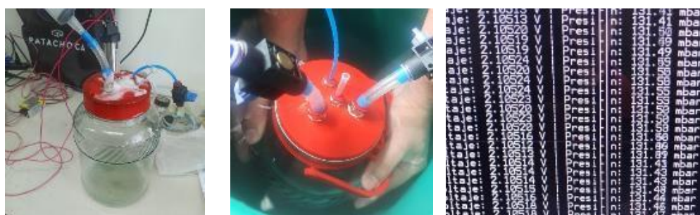
a) Prueba solución de jabón diluido. b) Prueba de burbujeo. c) Medición de presión.
