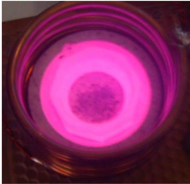
Fig. 11. Pieza de acero al carbón a una temperatura de 500 °C.
