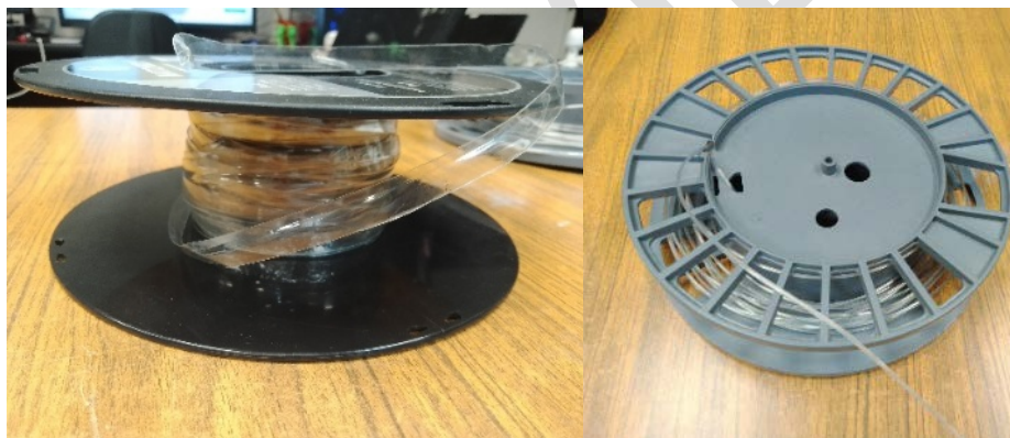
Figura 8 Material transformado en tiras de PET a filamento.
