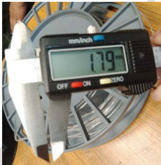
Figura 6 Medición del filamento con dimensión de 1.79 mm.
