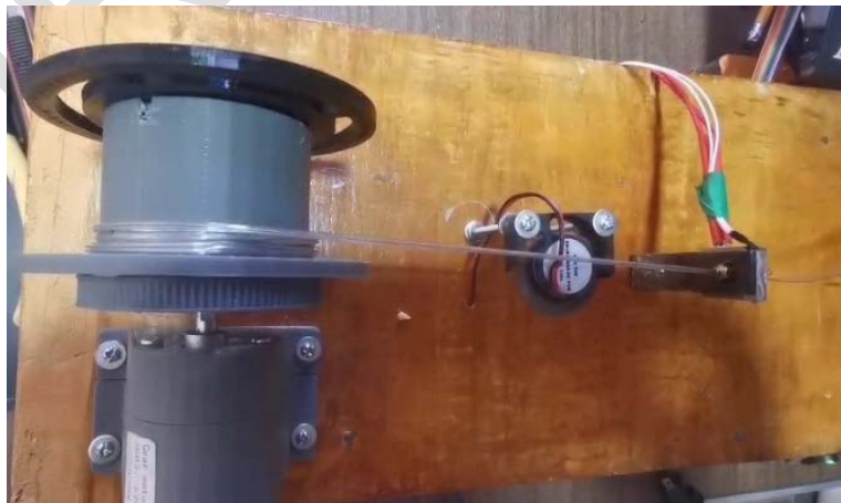
Figura 7 Vista superior del filamento saliendo de la boquilla.
