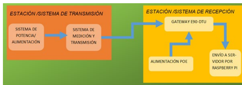
Figura 1 Diagrama a bloques del sistema de monitoreo remoto.
