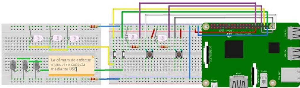
Figura 3 Diagrama de conexiones del sistema de iluminación y botones en la Raspberry.
