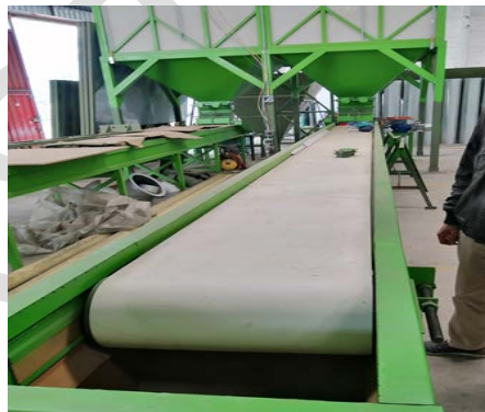
Figura 1 Cinta transportadora de café de la empresa CINTAGRO SA.
