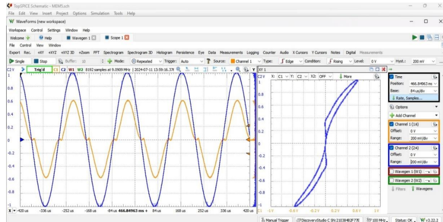
Figura 9 Obtención y análisis de las ondas de entrada y salida mediante WaveForms.
