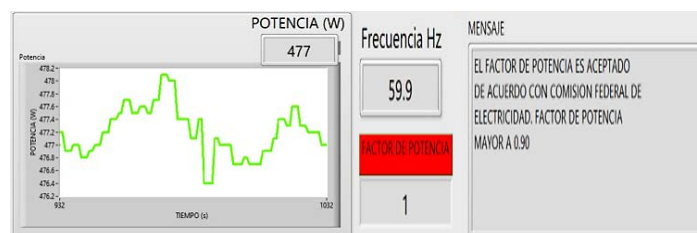
Figura 12 lectura de potencia, frecuencia y factor de potencia del prototipo.
