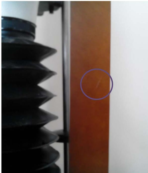
**Fig. 4. Defecto en la formación de las películas.**
