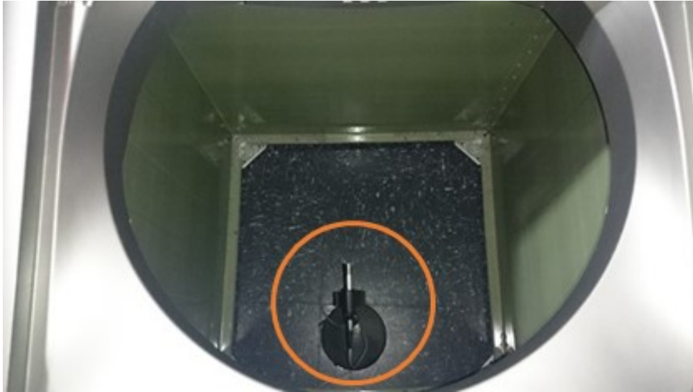
Fig. 6. Micrófono colocado en el interior del gabinete.
