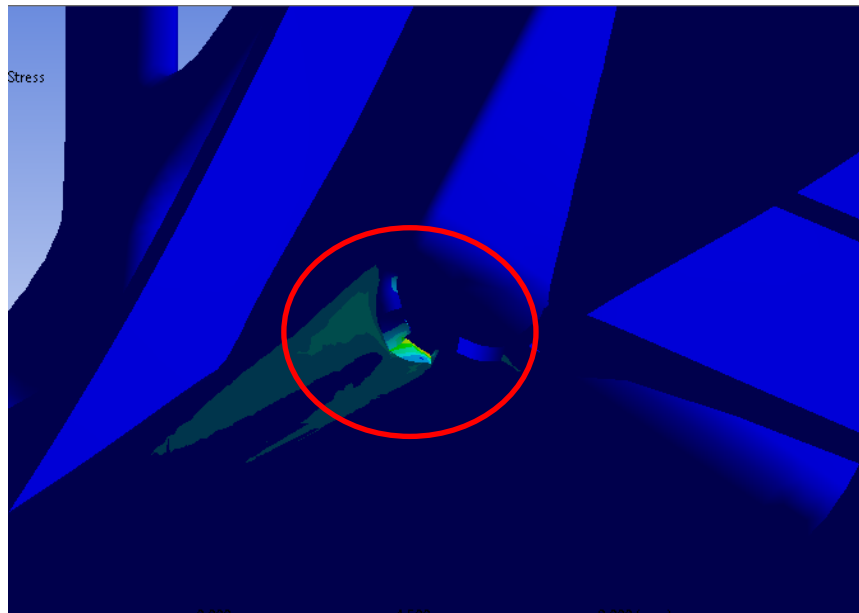
Fig. 15. Zona en la que se presenta el máximo esfuerzo de Von Mises
