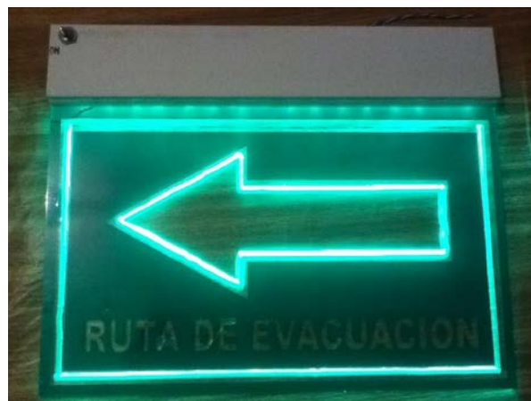
Fig. 10. Visibilidad de letrero de corte a 45°.
